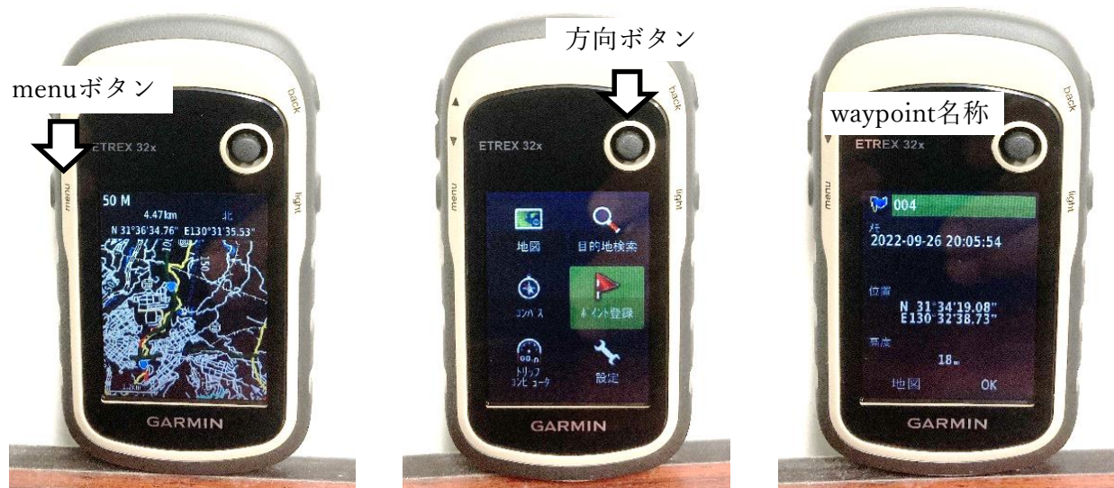
図1-4. GPS機器におけるwaypointの登録の流れ（GARMIN社製ETREX 32xの場合） 地図画面（左）でmenuボタンを押すと、menu画面（中）に移ります。次に、「方向ボタン」を長押し（1秒）すると、waypointの登録確認画面（右）に移ります。ここで、waypointの名称に、外来植物の写真ファイルに関連したもの（写真のファイル名や撮影時間）を付けます。
