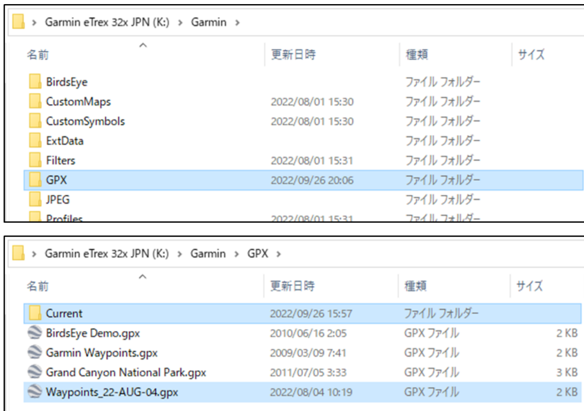
図3-10. GPS機器からGPSファイルを移動する流れ（GARMIN社製ETREX 32xの場合） GPS機器をパソコンに接続し、「Garmin」というフォルダを開くと、その中に「GPS」というフォルダ（2段目の図）があるので、その中のGPSファイル（GPX形式）とさらに「Current」というフォルダ内のGPSファイル（Current.gpx）をパソコンにコピーします。
